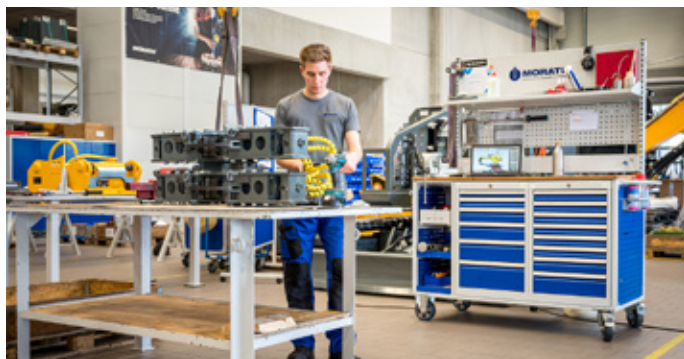
Flexibel und mobil einsetzbar sind die fahrbaren Werkbänke, so können die Mitarbeiter ganz einfach ihren Arbeitsplatz wechseln.
