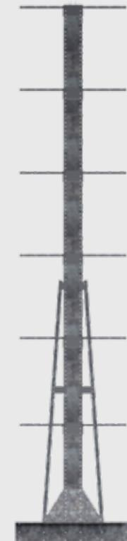
Das **WS20** Konzept bildet, je nach Deckenhöhe, bis zu sieben Ebenen mit 28 Rädern ab. Die Radsätze werden horizontal auf Auflagearmen gelagert und mit einem Räderlift umgeschlagen.
