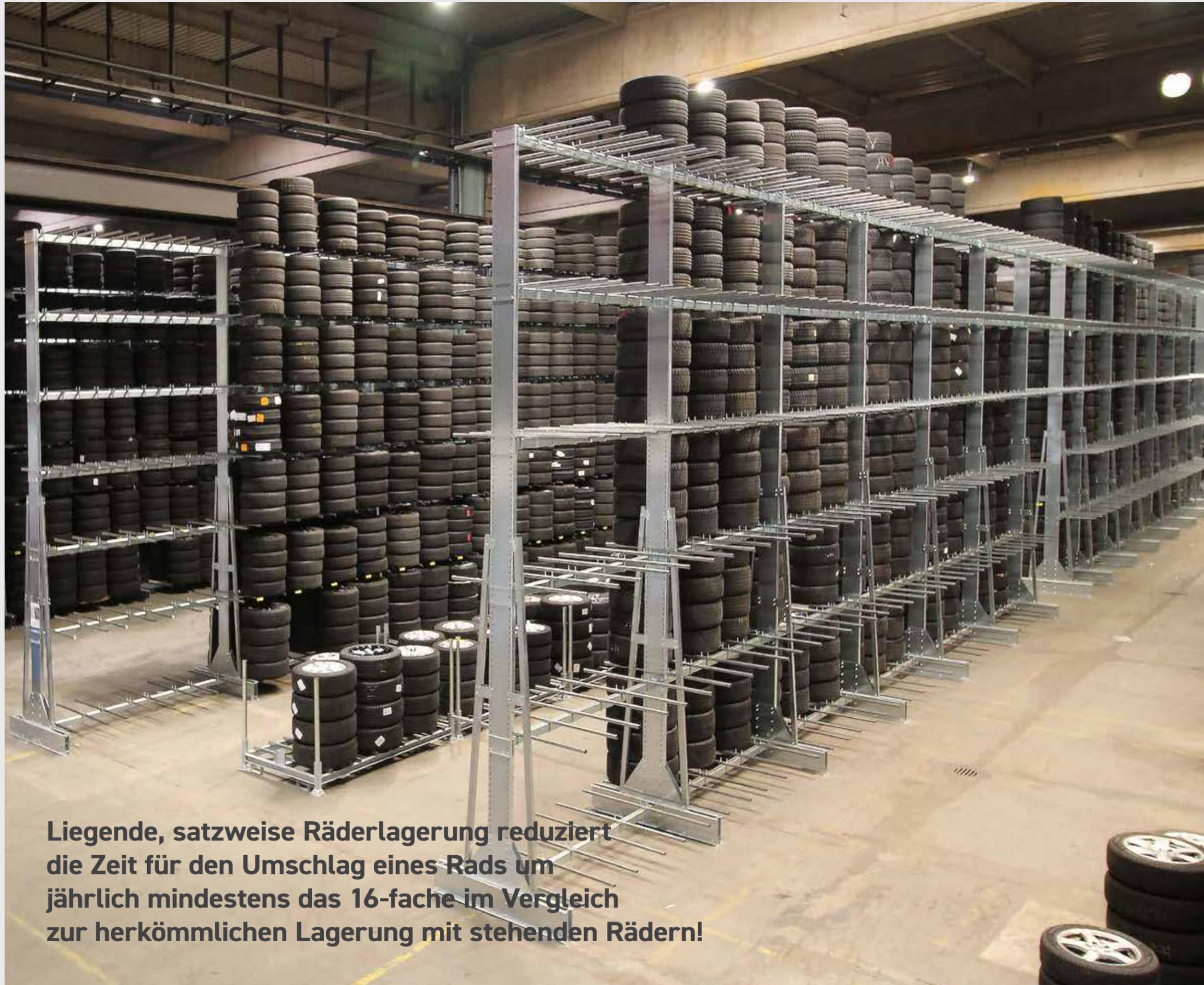
Liegende, satzweise Räderlagerung reduziert die Zeit für den Umschlag eines Rads um jährlich mindestens das 16-fache im Vergleich zur herkömmlichen Lagerung mit stehenden Rädern!
