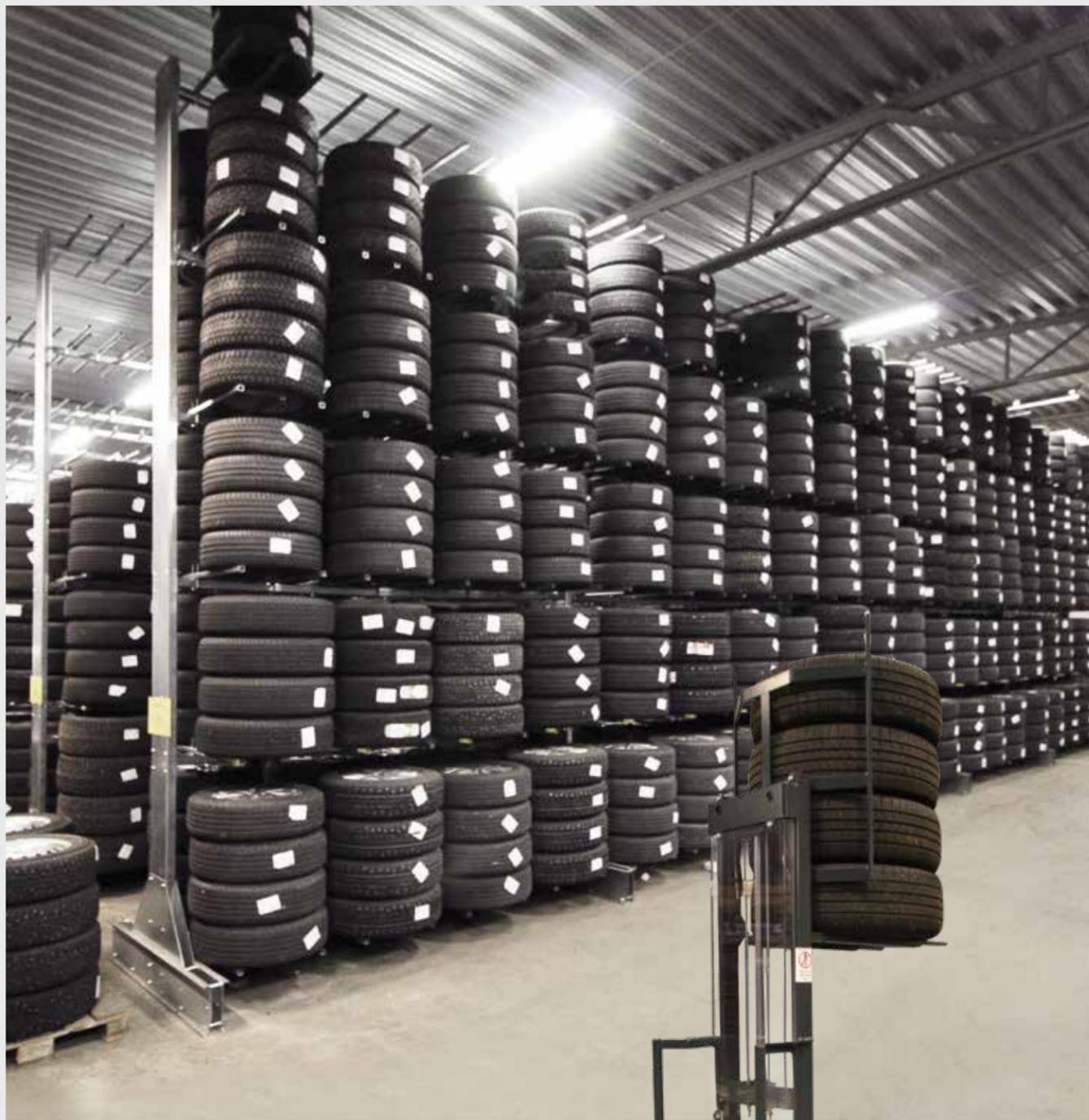
**WS342** Räderlift. Unser kleinstes Model, das 1 und 2 Ebenen bedient. Ideal zum Be- und Entladen von Transportkäfigen und Transportwagen.
