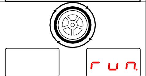
Na de balanceerloop verschijnt de weergave hiernaast. Nu kan de remprocedure worden gestart. Breng het kalibreergewicht (200g) aan op de binnenkant van de velg.
