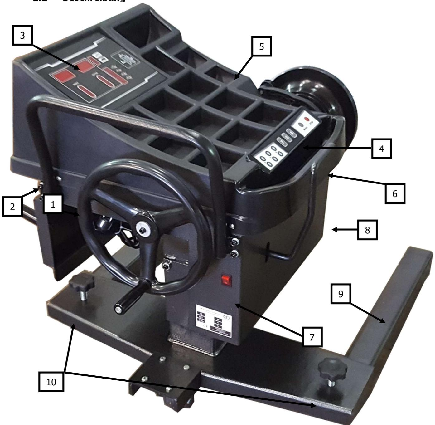
1. Handrad zum Heben und Senken der Wuchtmachine
