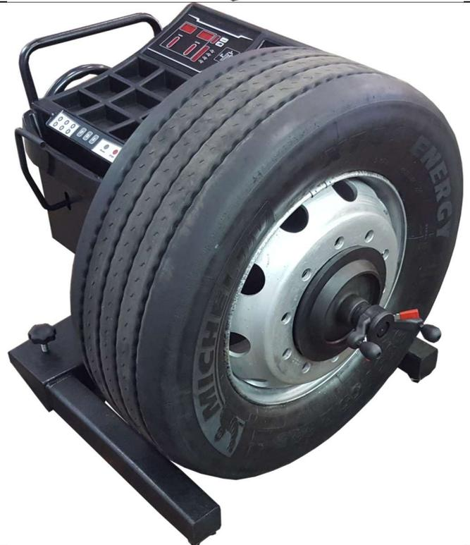
Falls sich die Felge nicht genau mittig auf der Welle befindet, kann mittels Drehen am Handrad die Höhe verstellt werden.
