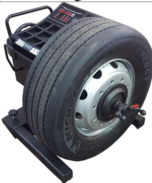
Si la llanta no se sitúa exactamente en el centro del eje, es posible ajustar la altura girando el volante manual.
