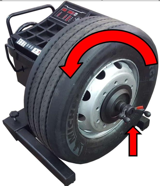
Zum Abschluss kann die Wuchteinheit und das Rad angehoben werden. Dieses sollte sich ca. 2 cm über dem Boden befinden.
