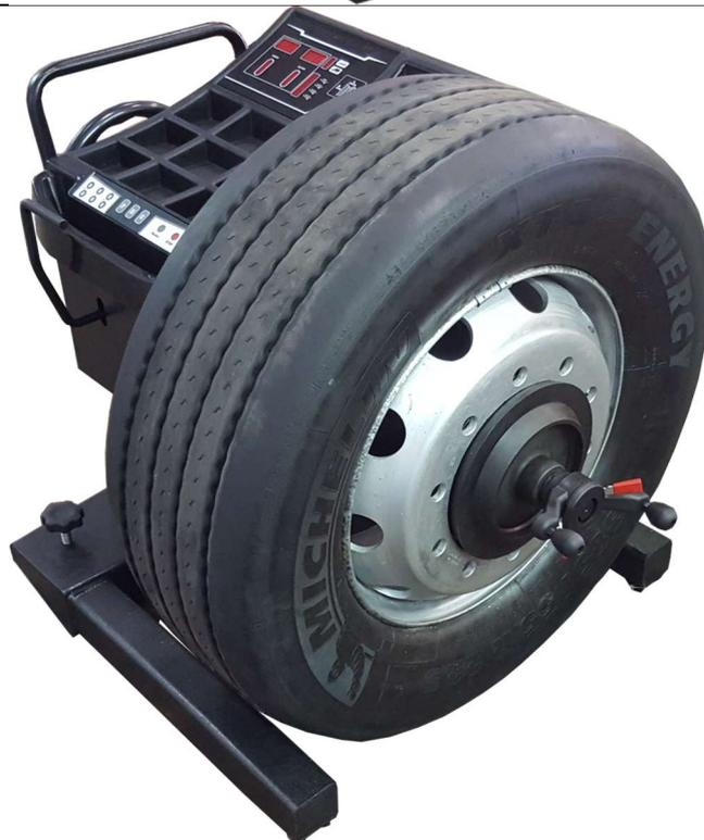
Si la jante n'est pas correctement centrée sur l'arbre, vous pouvez modifier la hauteur en faisant tourner le volant à main.
