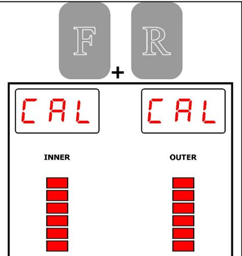
Nu kan de eerste cyclus worden gestart door het wiel te draaien. Zodra in de weergave "run." verschijnt, kan het handmatig draaien worden gestopt. Nu meet de machine de onbalans van het wiel.
