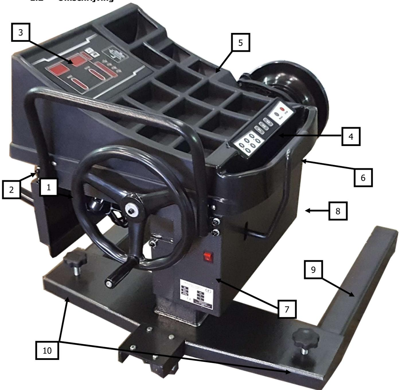
1. Handwiel voor het heffen en zakken van de balanceermachine
