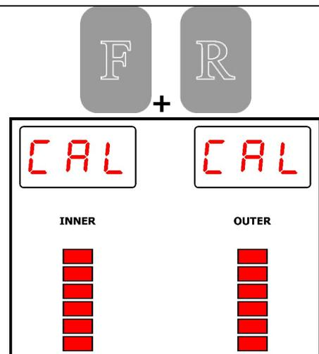
Poprzez pokręcenie kołem można rozpocząć pierwszy przebieg. Gdy tylko na wyświetlaczu pojawi się „run.”, można przerwać ręczne obracanie koła.
