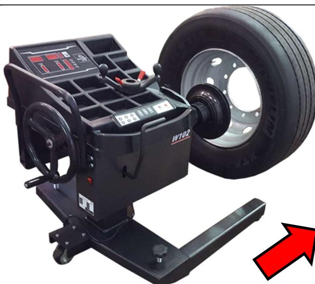
Coloque ahora el cono desde el exterior y asegúrelo contra caídas mediante una tuerca de sujeción.
