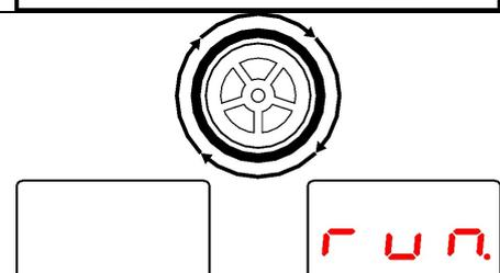
Po vyvažovacím chodu se zobrazí vedle uvedený ukazatel. Nyní lze zahájit proces brzdění. Kalibrační závaží (200 g) umístěte na vnitřní straně ráfku.
