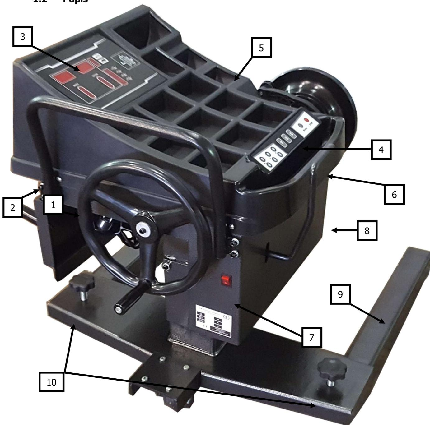
1. Ruční kolo ke zvedání a spouštění vyvažovacího stroje
