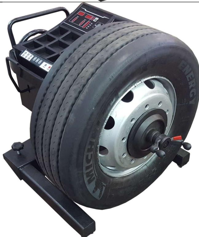
Pokud se ráfek nenachází přesně ve středu na hřídeli, lze výšku nastavit otáčením ručního kola.
