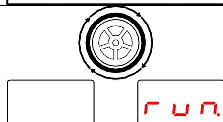
Po wykonaniu procesu wyważania pojawi się zamieszczone obok wskazanie.
