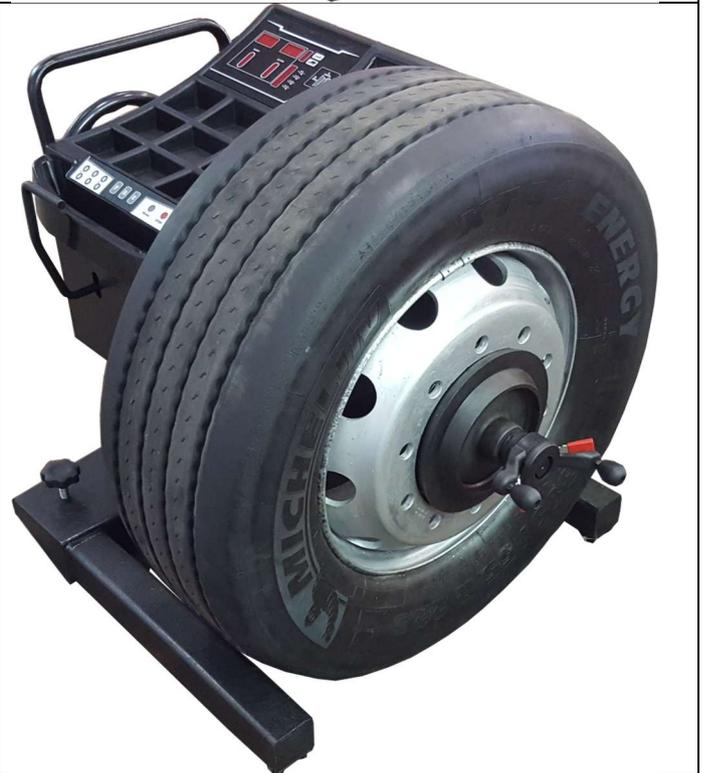
Als de velg zich niet exact in het midden op de as bevindt, kan de hoogte worden aangepast door het handwiel te draaien.
