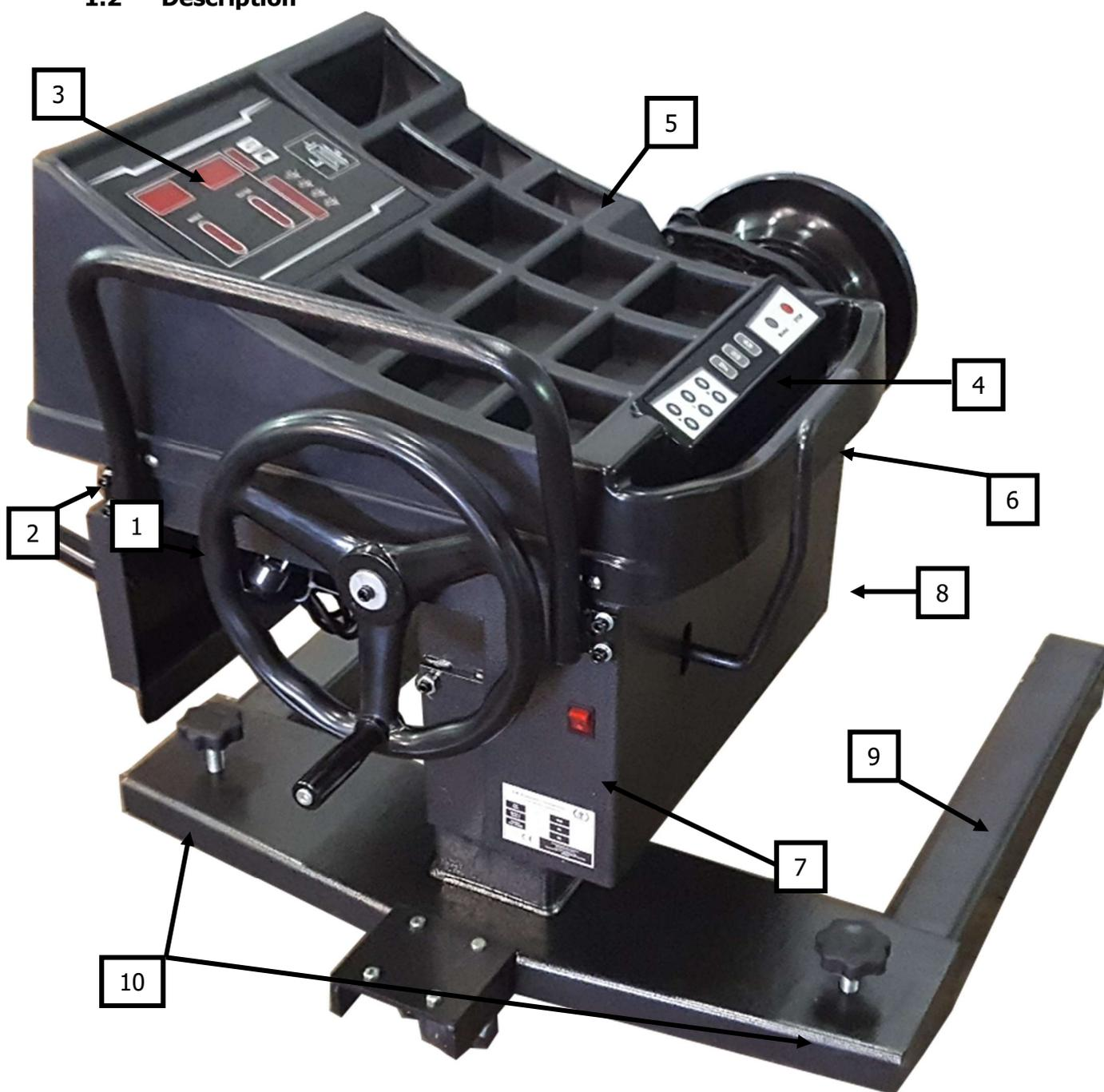
1. Volant à main pour lever et abaisser l'équilibreuse de pneus
