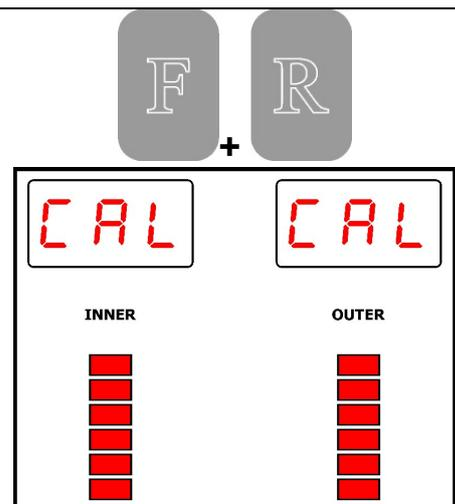
Otáčením kola lze nyní zahájit první chod. Jakmile se zobrazí na displeji „run“, lze manuální otáčení přerušit. Nyní stroj měří nevyváženost kola.
